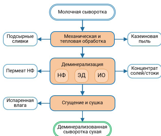
Рисунок 1. Принципиальная схема деминерализации молочной сыворотки
