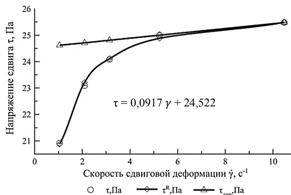
Рисунок 3 – График консистенции вязкопластичного материала до обработки ИЭП Figure 3 – Viscoplastic material thickness before treatment with pulse electric field
