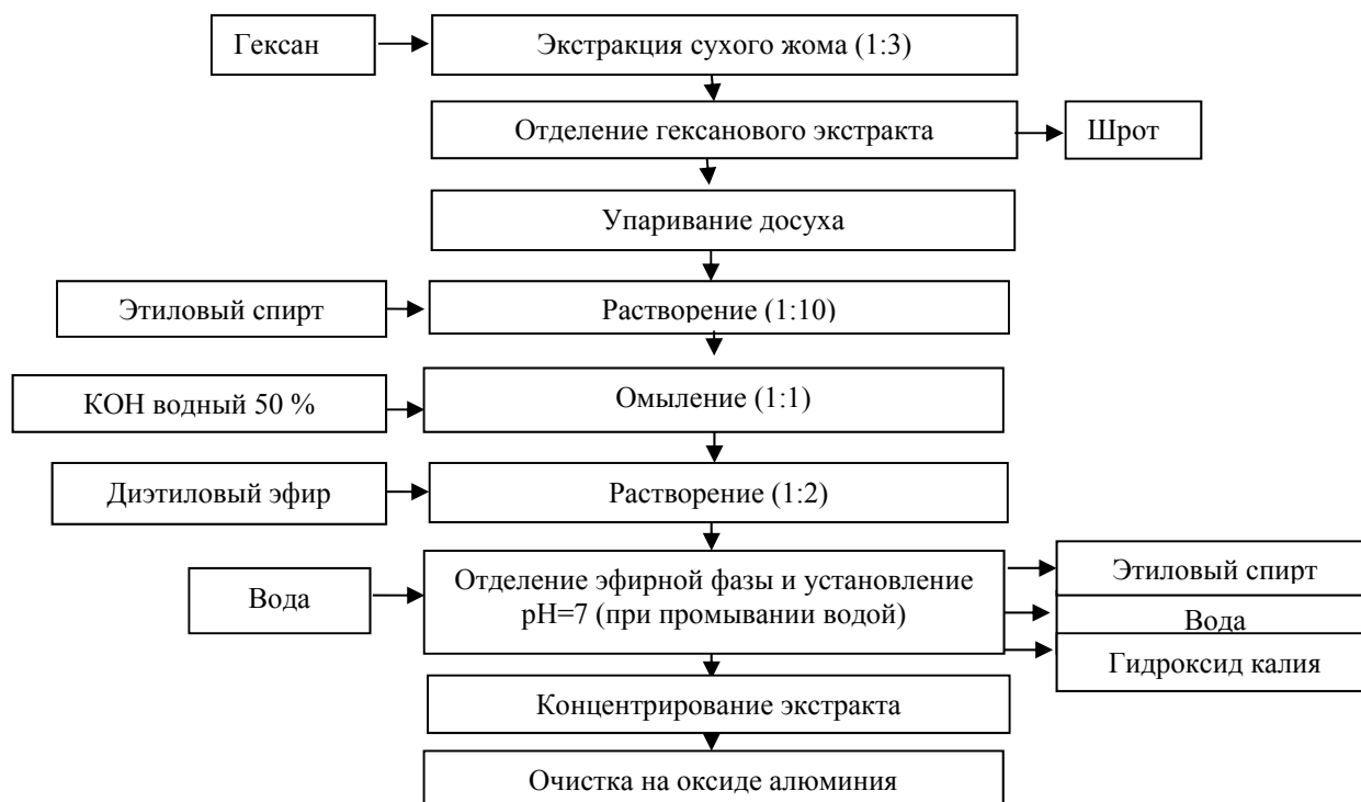
Рис. 3. Схема получения экстракта зеаксантина
