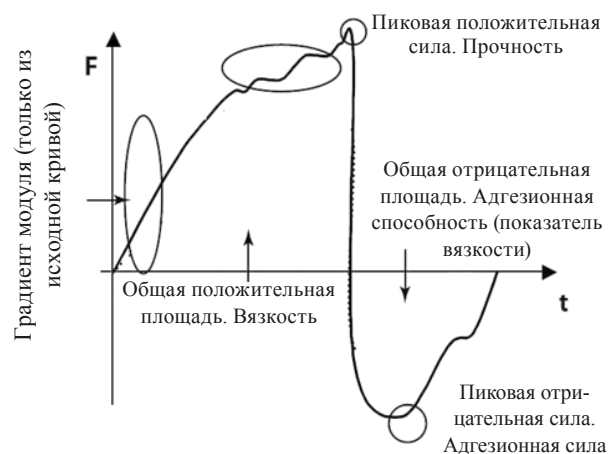
Рисунок 1 – Пример деформационной кривой, полученной на анализаторе СТ 3 Brookfield
