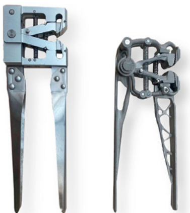
Рис. 2. Пример модернизации устройства для проверки поперечного шва асептического пакета
