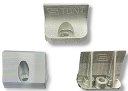
Рис. 3. Оригинальная и модернизированная деталь фальцовщика на машине розлива. Оригинальная деталь была подвержена значительным химическим воздействиям и со временем получила сильные повреждения даже при учете анодирования. Нам удалось заменить материал, из которого сделана оригинальная деталь, на более коррозионностойкий сплав, сохранив при этом ее вес, существенно увеличив прочность и полностью исключив химическое воздействие. Все это позволяет увеличить срок эксплуатации детали
