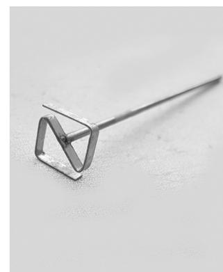
Рисунок 2. Прибор «Реокон-2»: а) внешний вид прибора, б) индентор Z-образный
