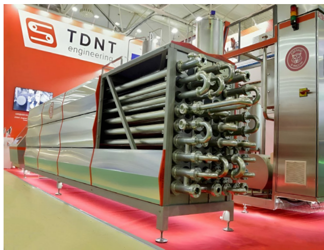
Трубчатый теплообменник, входящий в состав установки ультрапастеризации TDNT ULTRA 7, на выставке «Агропродмаш-2024», г. Москва
