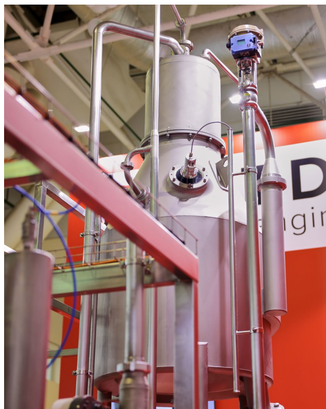
Деаэратор в составе установки ультрапастеризации TDNT ULTRA 7 на выставке «Агропродмаш-2024», г. Москва
