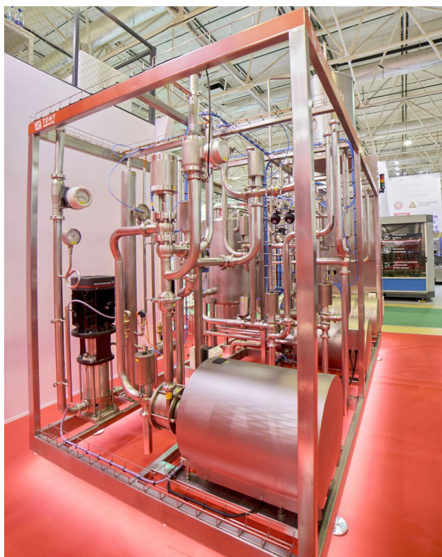
Модуль установки ультрапастеризации TDNT ULTRA 7 на выставке «Агропродмаш-2024», г. Москва
