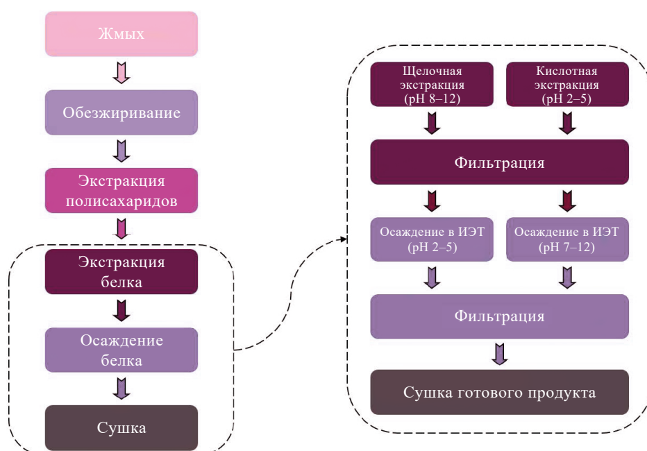
Рисунок 1. Получение изолята растительного белка (ИЭТ – изоэлектрическая точка)
