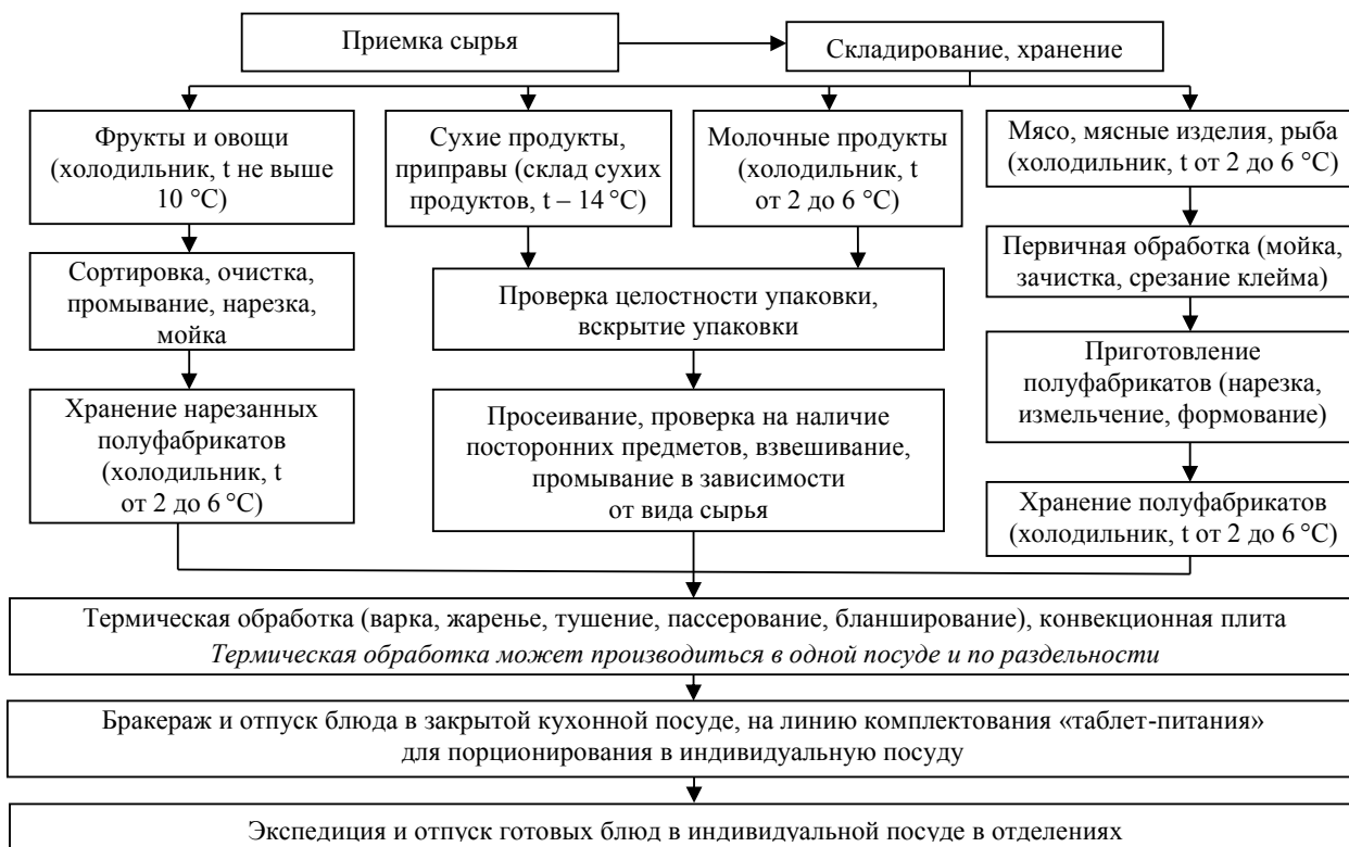
Рисунок 2 – Блок-схема технологического процесса приготовления вторых блюд
