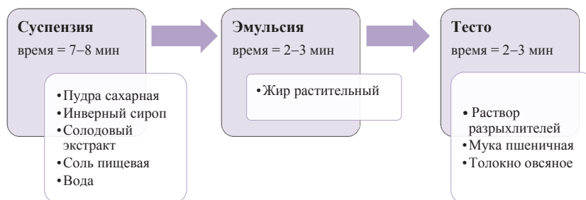
Рисунок 7. Технологическая схема приготовления теста для печенья по трехстадийной технологии
